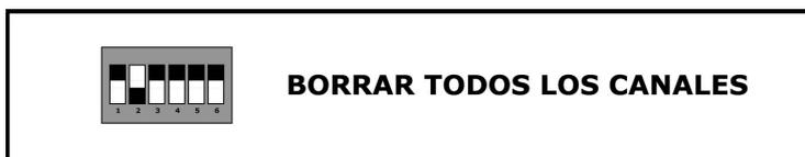
**Paso 3:** Poner los switches en la posición que muestra la siguiente figura.
