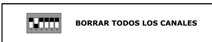
**Paso 3:** Poner los switches en la posición que muestra la siguiente figura.
