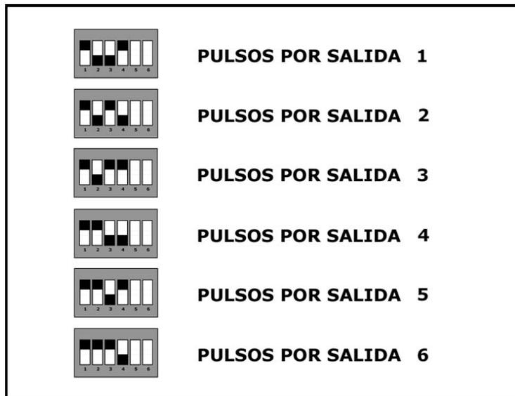
**Paso 4:** Seleccionar la cantidad de pulsos que queremos que sean entregados por la salida (utilizando las palancas 5 y 6), según la siguiente tabla.
