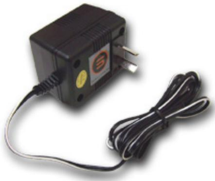
Para utilizar con billetero se necesita que la alimentación sea provista por una fuente switching de 12v 2000mA. (si el billetero posee stacker puede necesitarse una fuente de mas corriente).
